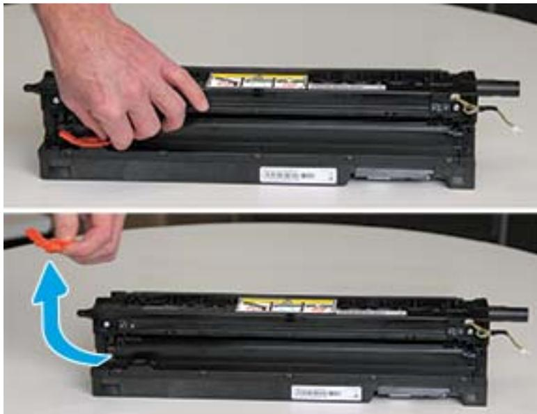
**⚠ 注意：**卸下插头后，成像装置必须保持水平。如果成像装置倾斜，其中的液体可能会溢出。
